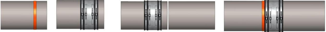
① Am Rohr mit dem größeren Außendurchmesser eine Markierung anbringen, die der halben Kupplungsbreite entspricht.
