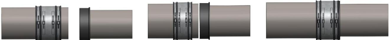
① Spannschlösser lösen und die Kupplung über die Rohrleitung mit dem größeren Außendurchmesser schieben.
