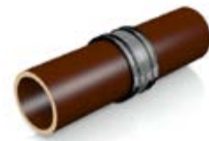
Kupplung mittig über beide Spitzenden schieben und Schösser wechselseitig anziehen.
