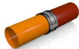
Kupplung mittig über beide Spitzenden schieben und Schösser wechselseitig anziehen.
