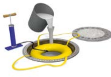
Schlauchschalung positionieren und aufpumpen. Mörtel in Gießrohr einfüllen.
