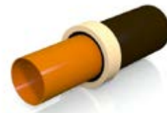
Spitze in Muffe einschieben.
