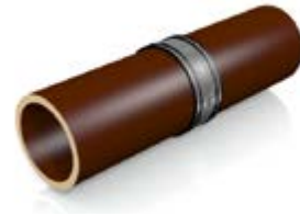
Kupplung mittig über beide Spitzenden schieben und Schösser wechselseitig anziehen.
