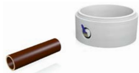
Gleitmittel auf Dichtung auftragen.
