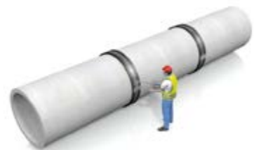
Kupplung mittig über beide Spitzenden schieben und Schösser wechselseitig anziehen.
