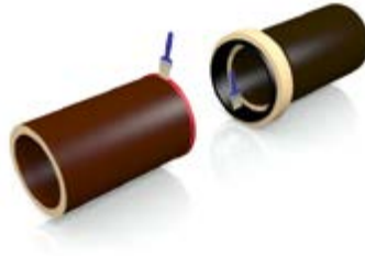
Gleitmittel auf Spitzendichtung und in Muffe auftragen.
