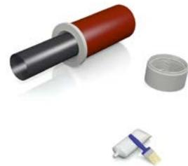
Gummiadapter in größeres Rohr einsetzen, Gleitmittel auf Rohrspitzende auftragen und kleineres Rohr einschieben.
