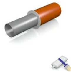
Kleineres Rohr in den Gummiadapter schieben.
