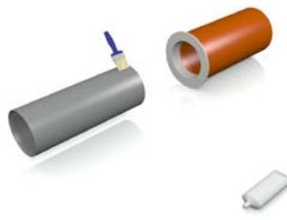
Gummiadapter in größeres Rohr schieben.
