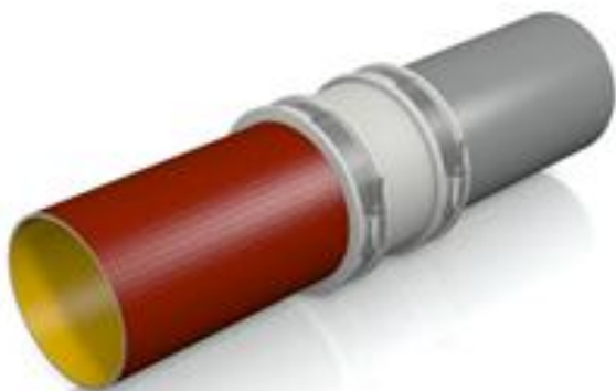
Abb.-2 Fachmännische Übergangslösung von SML- auf HT-Rohr mittels korrosionsresistenter Kupplung MDC Foto: Mücher Dichtungen
